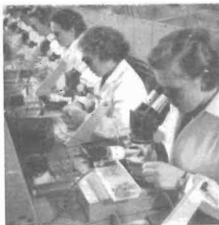
Controllo e applicazione dei terminali alle minuscole sferette di indio (emettitore e collettore) ed al sottilissimo strato di germanio n (base). (foto Philips)
